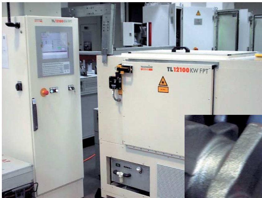
Специализированная лазерная установка для маркировки коленчатых валов в гибкой поточной линии
