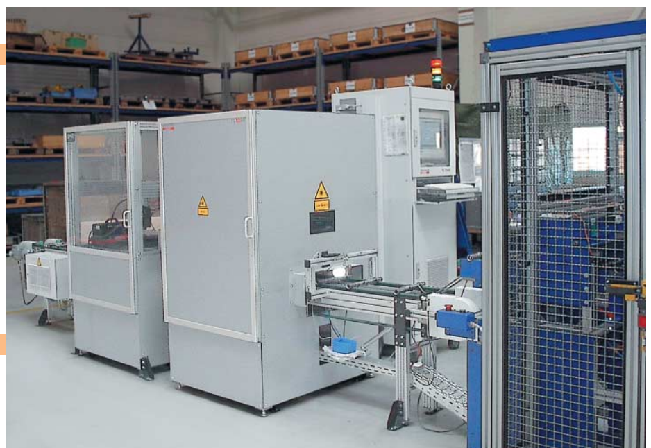
Поточная линия лазерной маркировки и контроля распределительных валов
